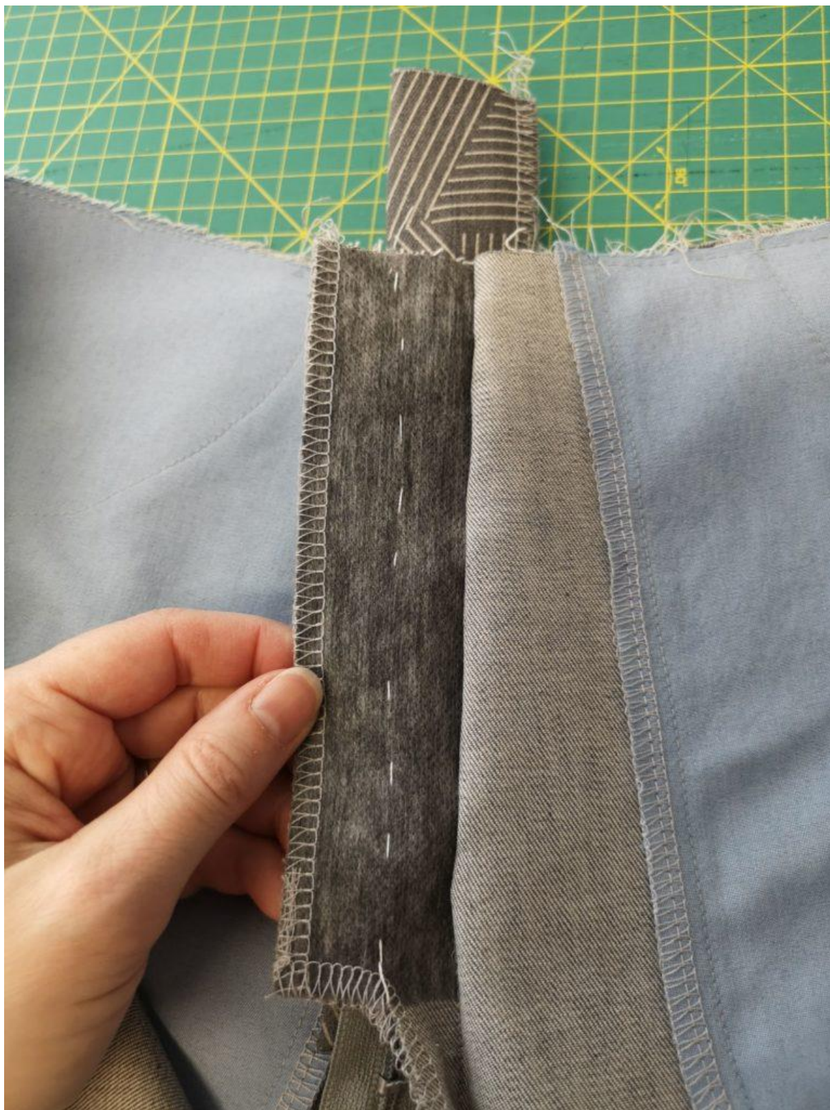
52. Nastehujeme pouzete na podkryt. Dejte pozor abyste nesestehovali skrz na skrz celými kalhotami.
