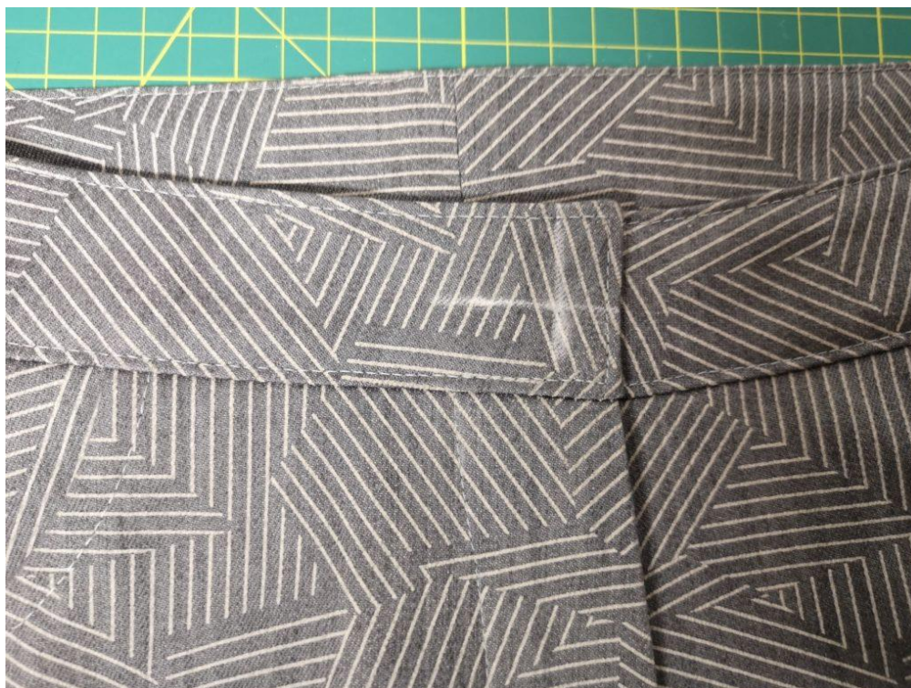
80. Na pravý PD si naznačení umístění knoflíkové dírky. Dírka je cca 1 - 1,5 cm od středu PD (záleží na vel. knoflíku)
